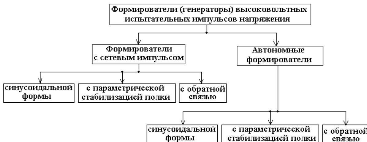
Рис. 1. Классификация формирователей высоковольтных испытательных импульсов
