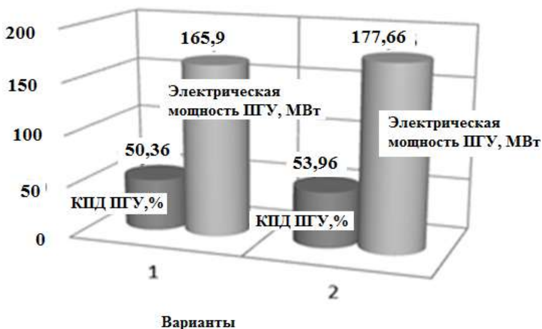
Рис. 4. Изменение КПД и электрической мощности ПГУ
