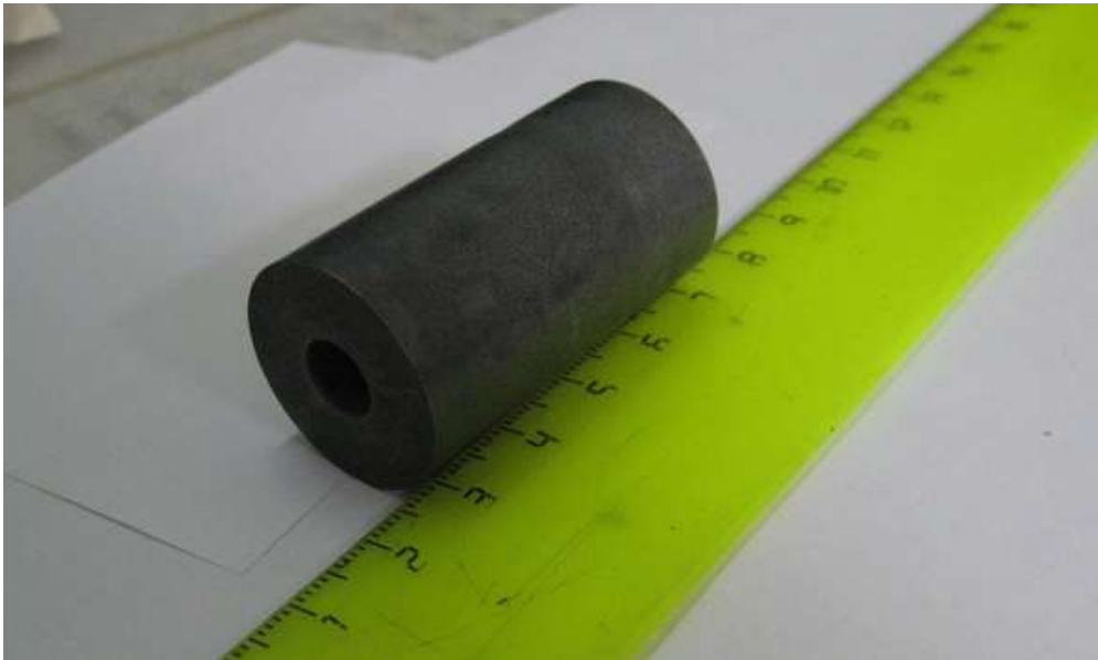
Рис. 1 Заготовка из спечённого твердого сплава под мелко модульную червячную фрезу
