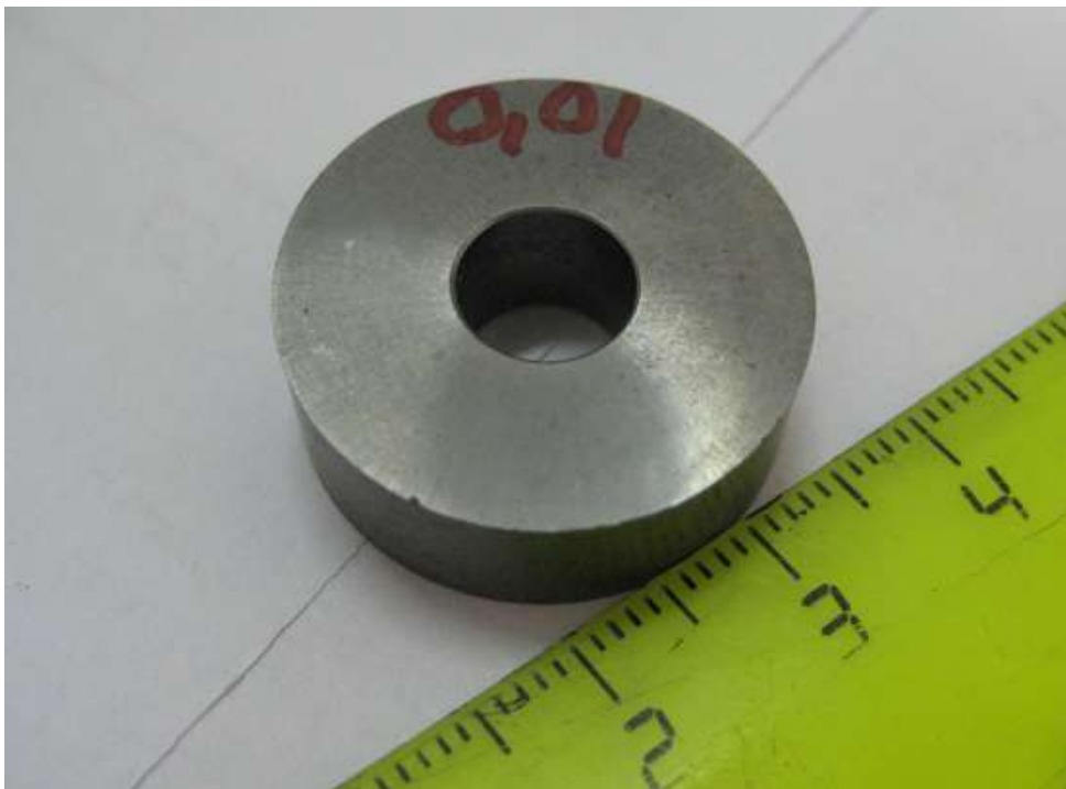
Рис. 2. Вырезанная заготовка из спечённого твёрдого сплава под мелко модульную червячную фрезу на электроэрозионном станке
