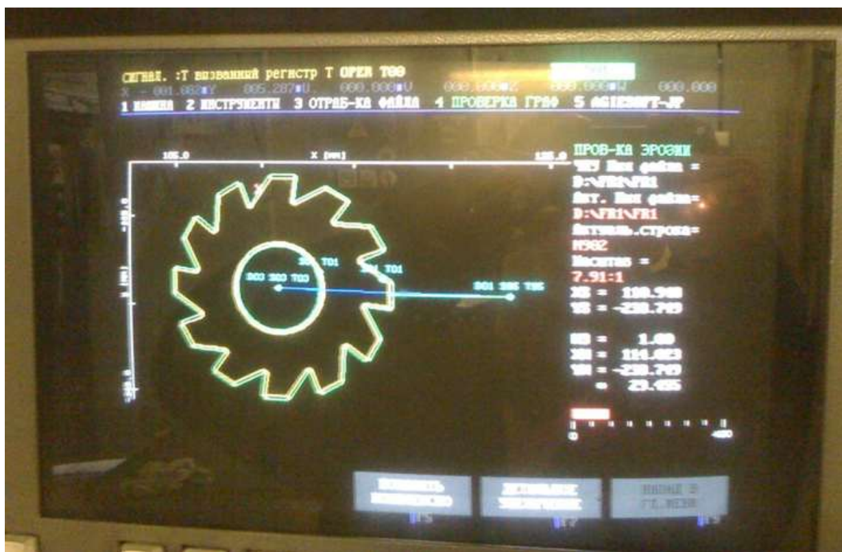
Рис. 8. Программа ЧПУ на экране электроэрозионного станка
