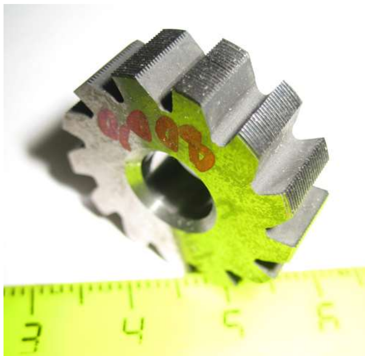
Рис. 4. Затылованная мелко модульная твёрдосплавная червячная фреза
