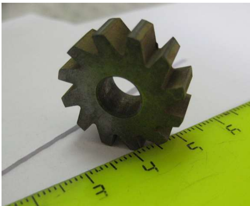
Рис. 3. Заготовка мелко модульной твёрдосплавной червячной фрезы с вырезанными стружечными канавками на электроэрозионном станке
