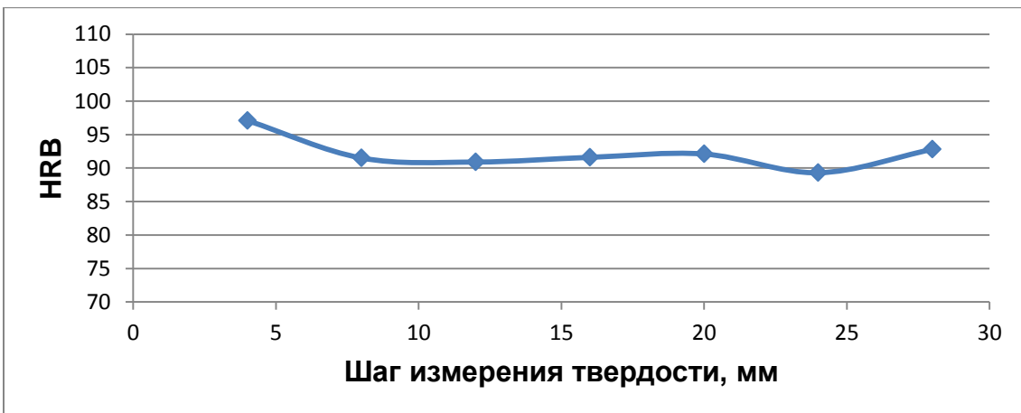
Рис. 5. Результаты замеров твердости сварного шва, выполненного с ультразвуковой обработкой
