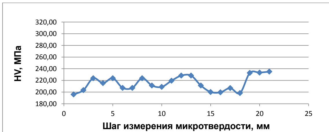
Рис. 7. Результаты замеров микротвердости сварного шва, выполненного с вибрационной обработкой
