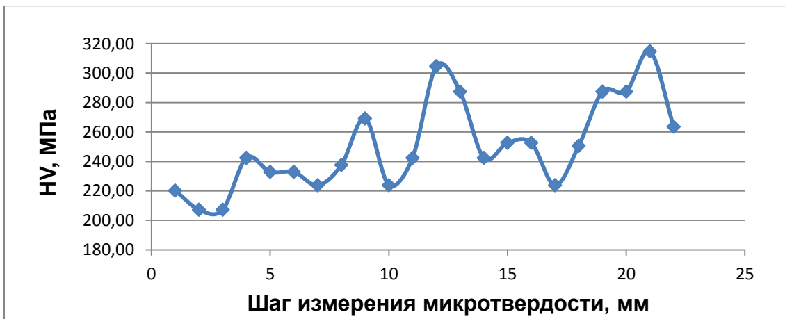
Рис. 9. Результаты замеров микротвердости сварного шва, выполненного без обработки
