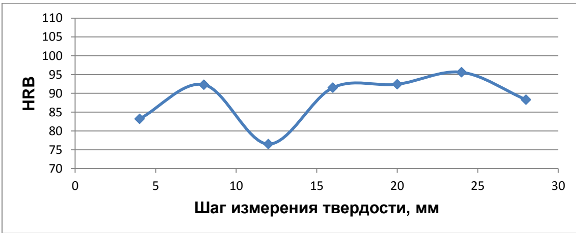
Рис. 4. Результаты замеров твердости сварного шва, выполненного с вибрационной обработкой
