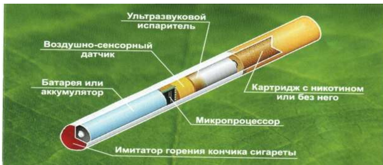
Рис. 2. Схема конструкции электронной сигареты
