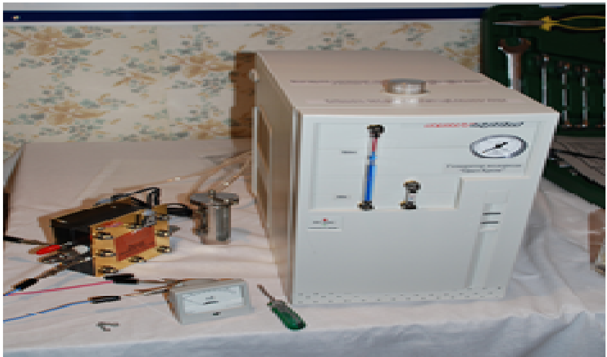
Рисунок 2. Министенд на основе исследовательской топливной ячейки и электролизера
