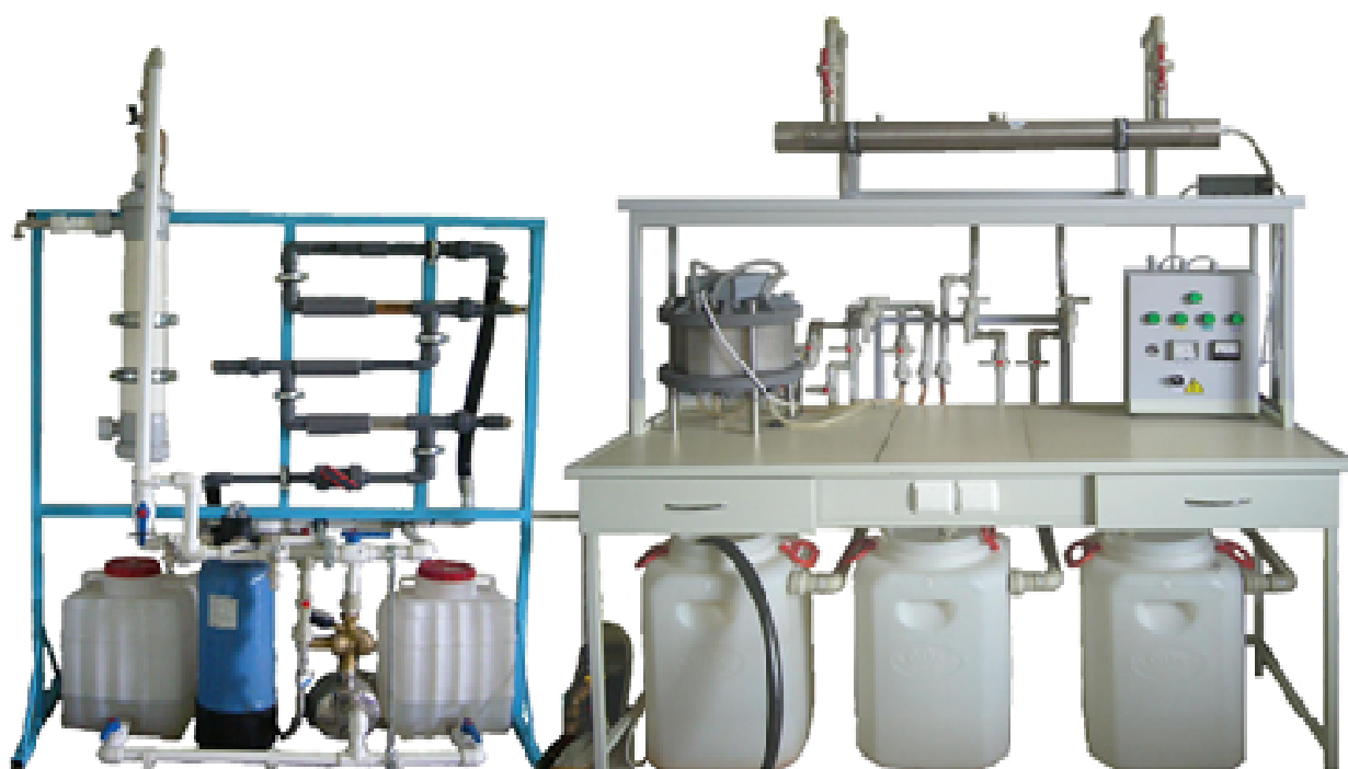
Рисунок 3. Общий вид комбинированной водоподготовительной установки
