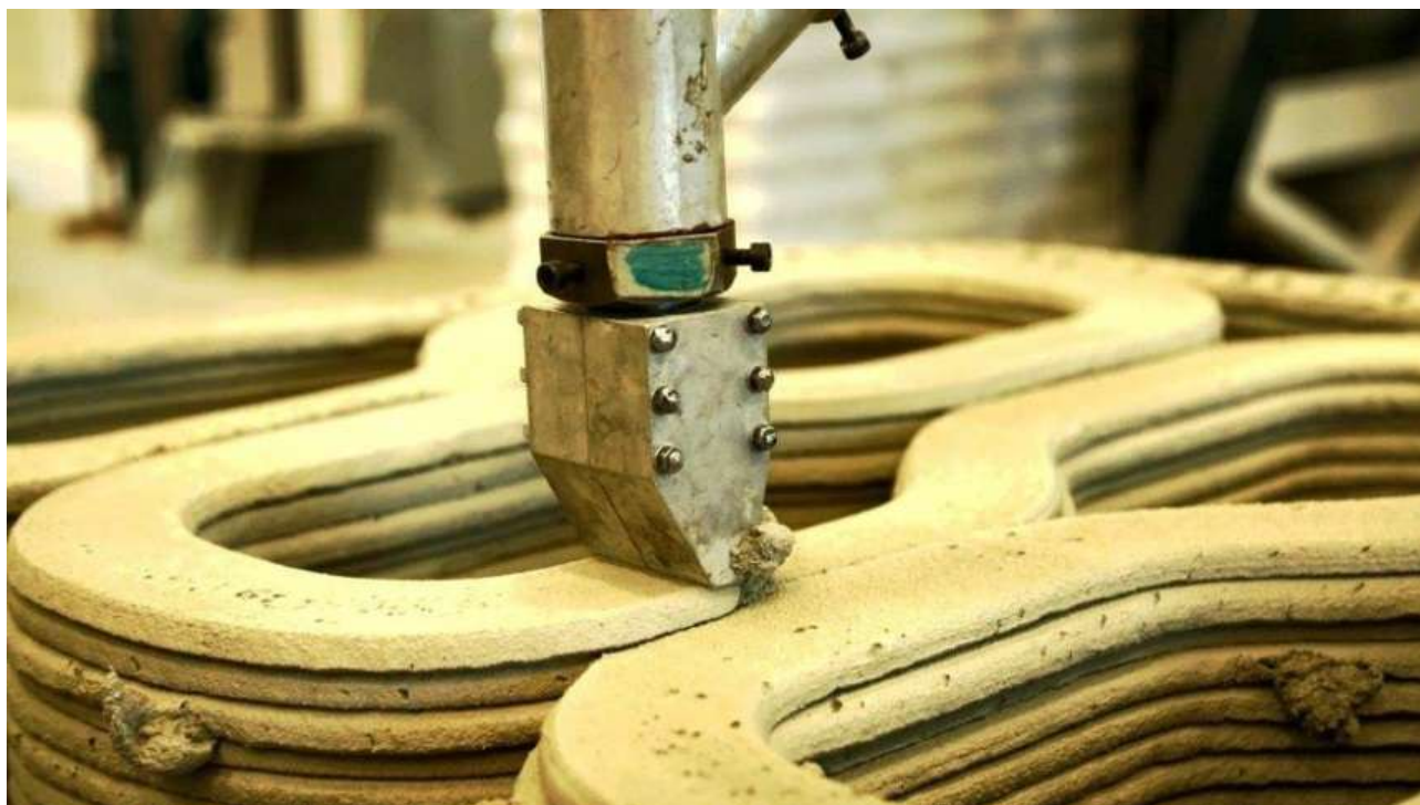
Рис. 2. Строительный принтер TU/e
