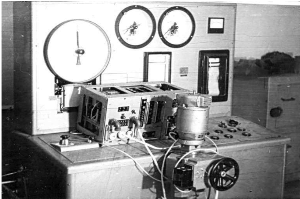
Рис. 3. Система стабилизации внутреннего давления
