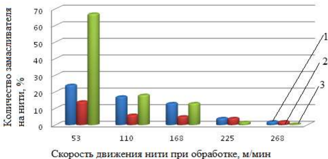
Рис. 2. Влияние скорости обработки на содержание замасливателя на полиамидной нити: 1 – Limanol 35F; 2 – замасливатель Б-73; 3 – Терон Н-353
