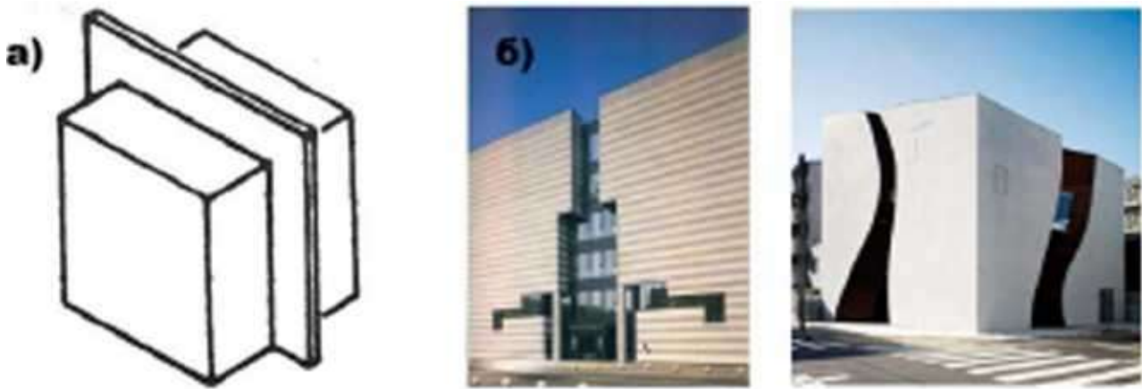
Рис. 9. Расчленение: а – схема; б – офис текстильной компании Sunwell, Токио, Япония, в – пример
