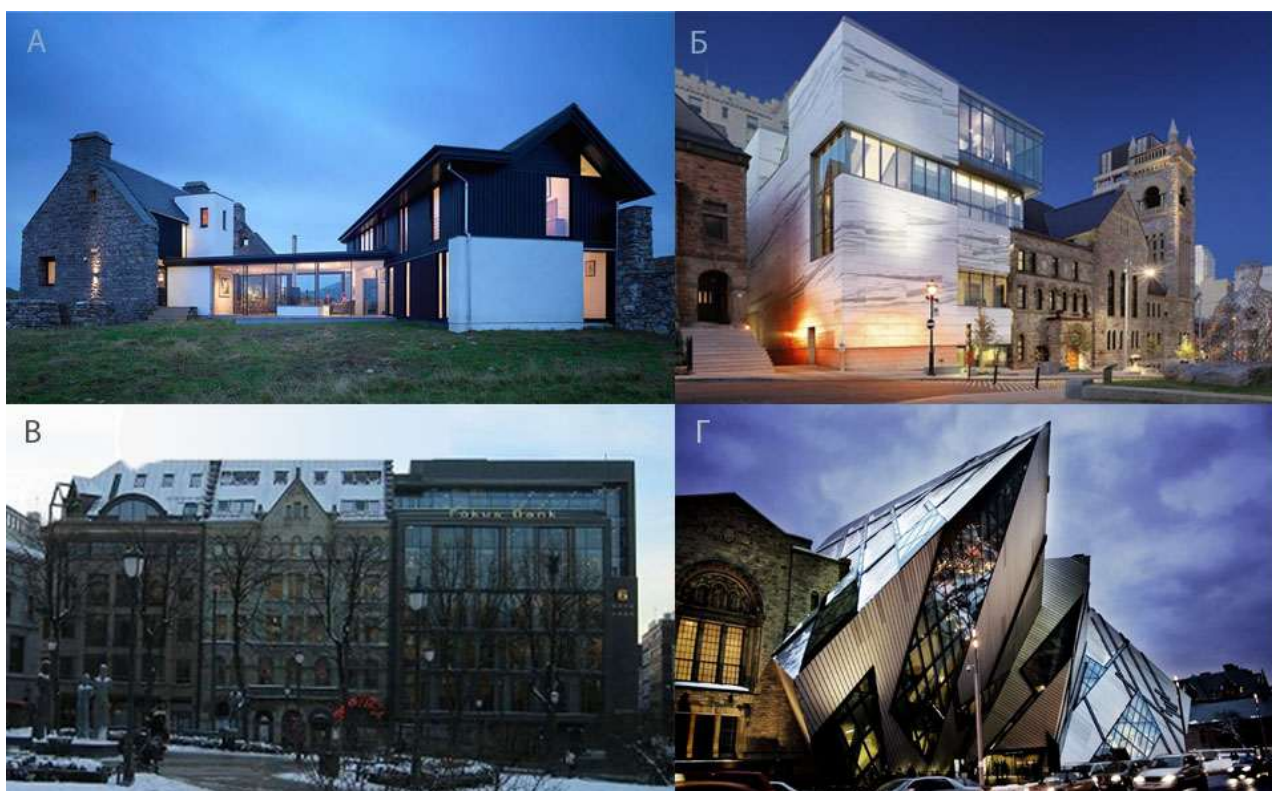
Рис. 1. Типы соединений новых зданий и исторической застройки: а– симбиоз «старого и нового», б – принцип подчинения, в – «вписывание» в историческую застройку, г – контраст;
